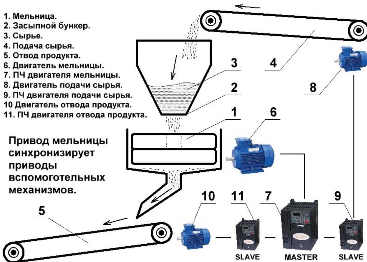
Пример синхронизации работы нескольких ПЧ.
